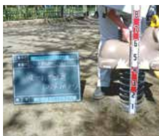
落下高さの測定
